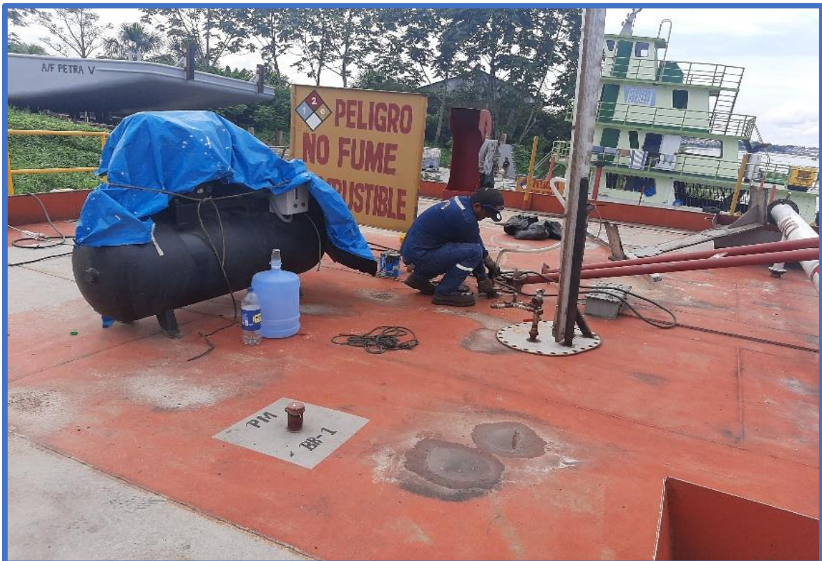
Vista fotográfica N° 24: Prueba hidrostática Maniflod 150 psi
