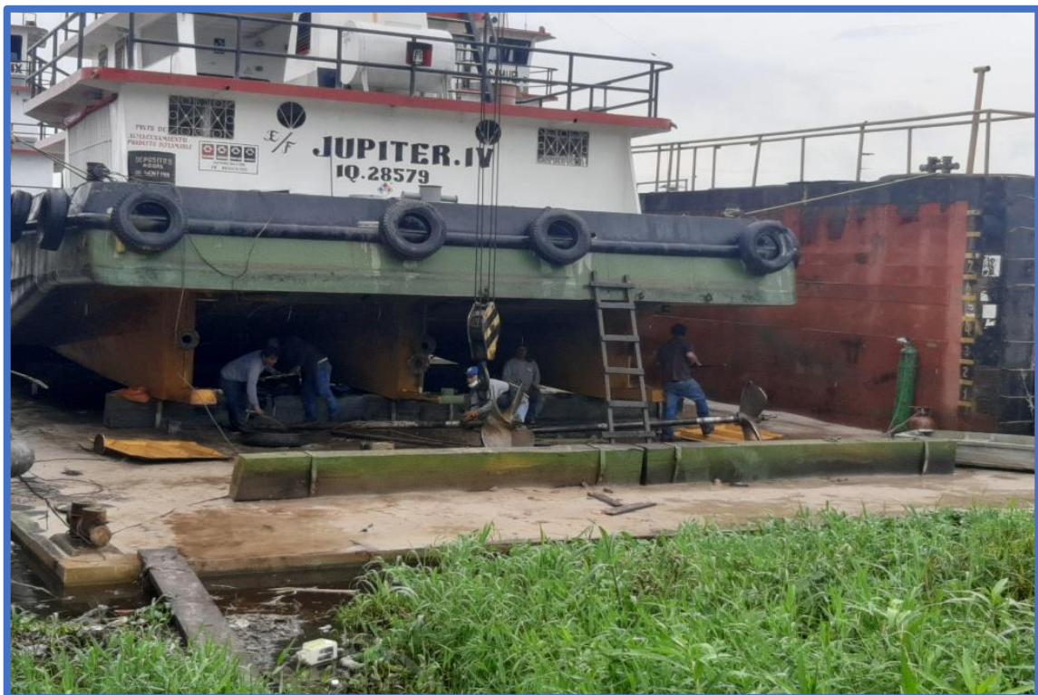
Vista fotográfica N° 18: Mantenimiento de propulsión EF JUPITER IV
