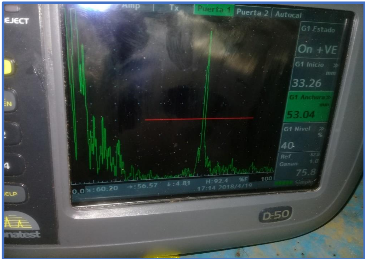
Vista fotográfica N° 11: Calibración de equipo de ultrasonido Ejemplo de defecto encontrado en el equipo
