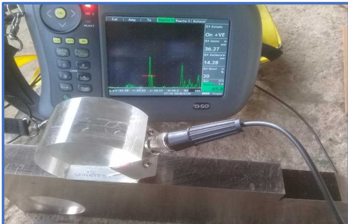
Vista fotográfica N° 10: Calibración de equipo de ultrasonido
