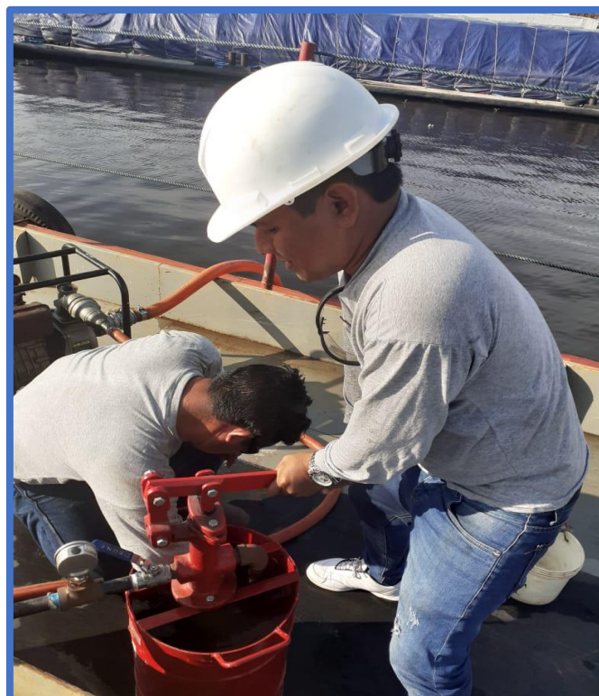
Vista fotográfica N° 24: Prueba hidrostática Maniflod 150 psi
