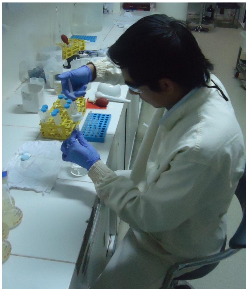
Fig N° 5: Terminada la Centrifugación, se Procede a Filtrarlas a través de Filtro Jeringa y se Colocan en Viales para sus Respectivas Inyecciones en el Sistema HPLC.
