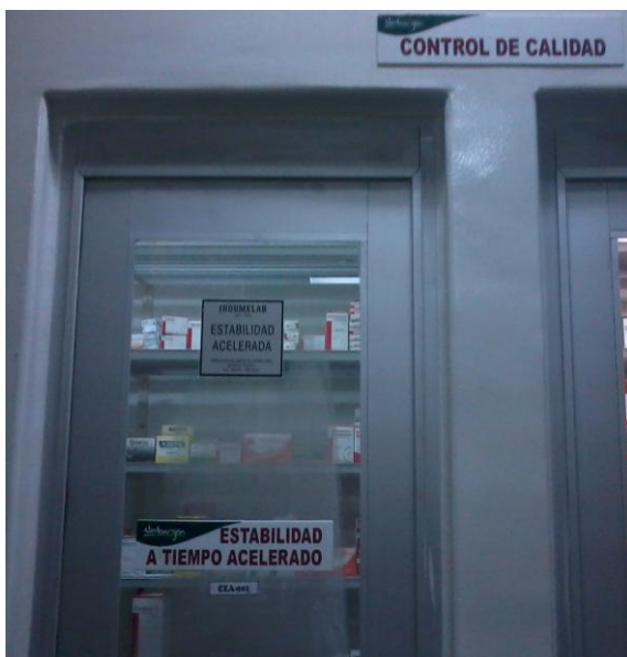
Fig N° 3: Muestras Sometidas a Humedad Relativa en la Cabina de Estabilidad a Tiempo Acelerado
