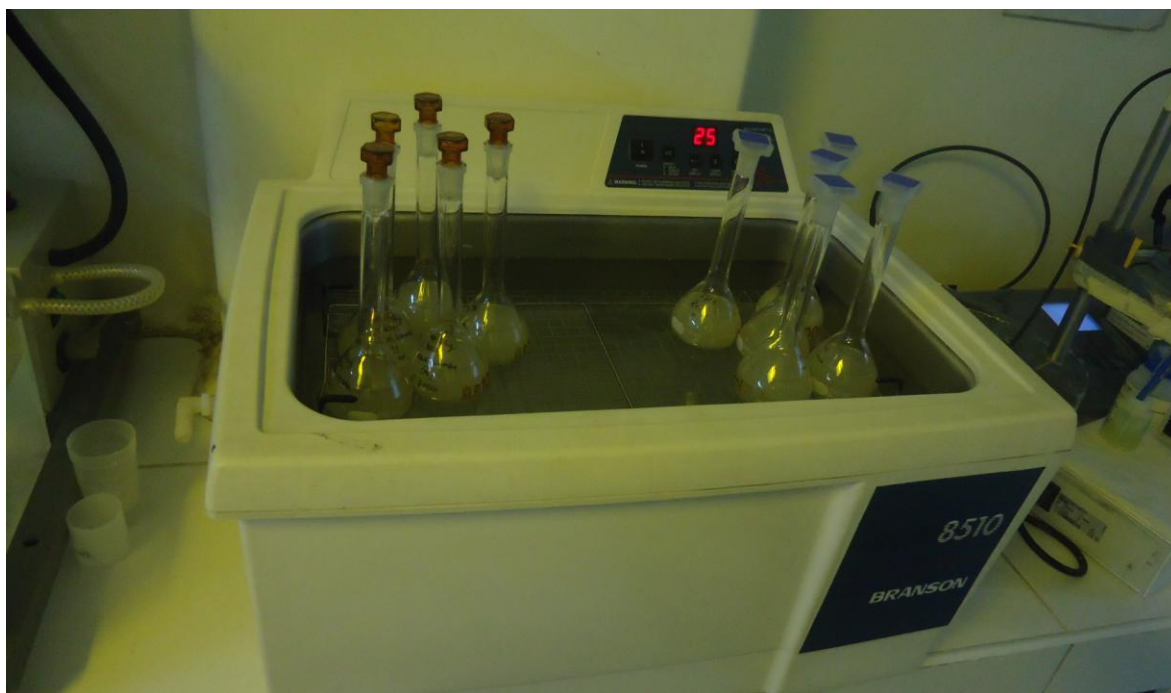
Fig N° 2: Muestras Sometidas al Ultrasonido Conteniendo 70 mL de Solución Diluyente
