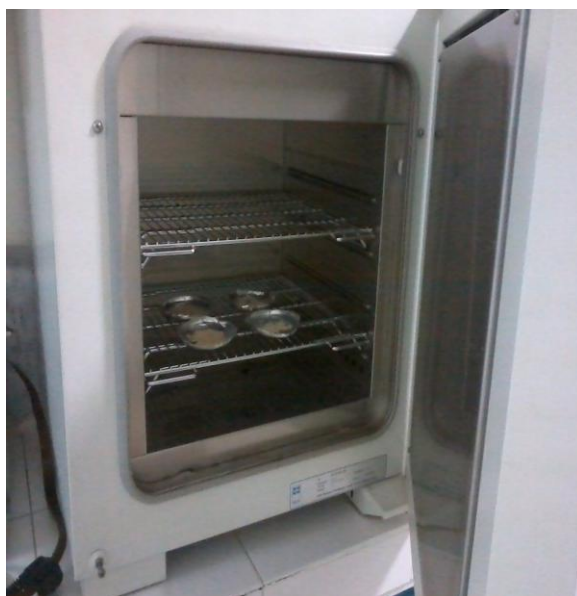
Fig N° 4: Muestras Sometidas a Temperatura de 70°C
