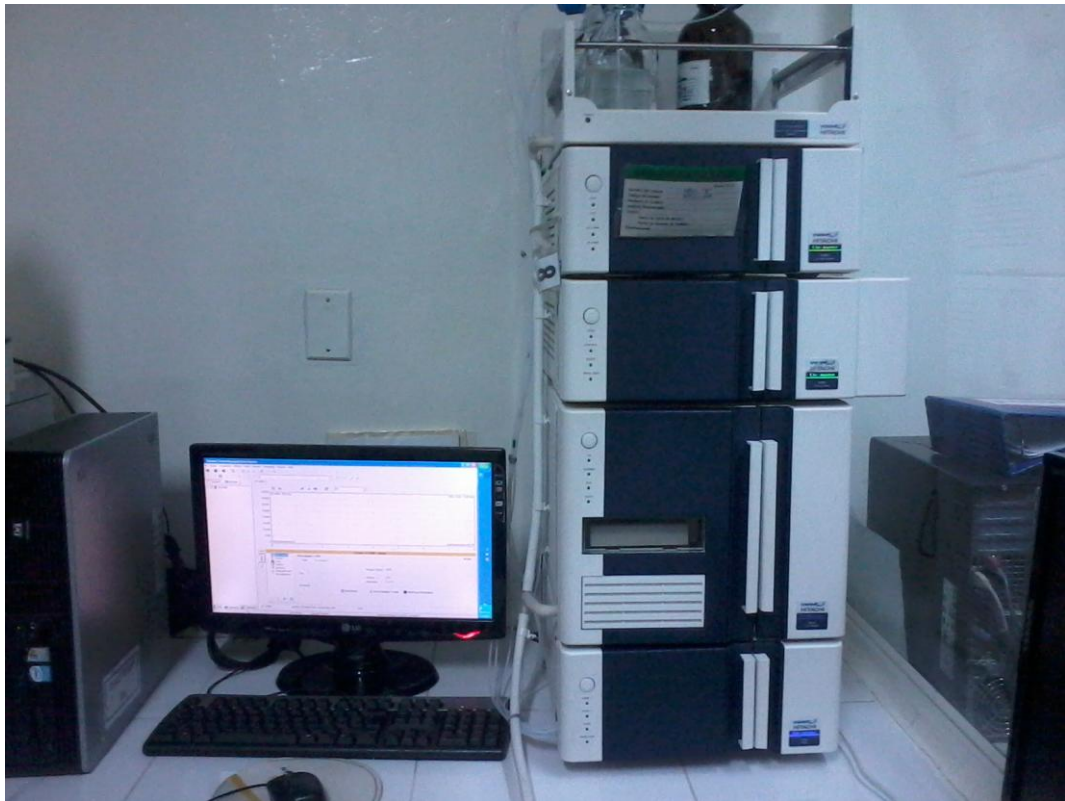
Fig N° 5: HPLC Acoplado con Detector de Diodos (DAD)
