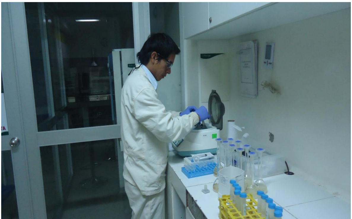
Fig N° 4: Luego del Enrasado se Depositan a Tubos de Centrifuga y se les Realiza la Centrifugación a 50 r.p.m. por 5 minutos
