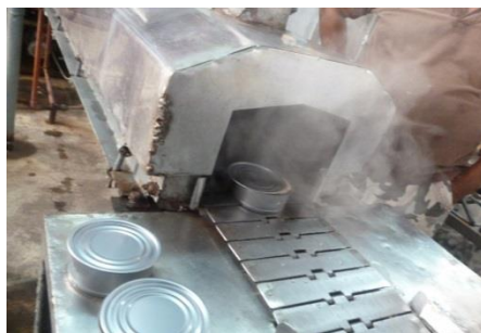
Figura N° 17: Desplazamiento de las conservas de Gamitana Ahumada a través del túnel del exhauster
