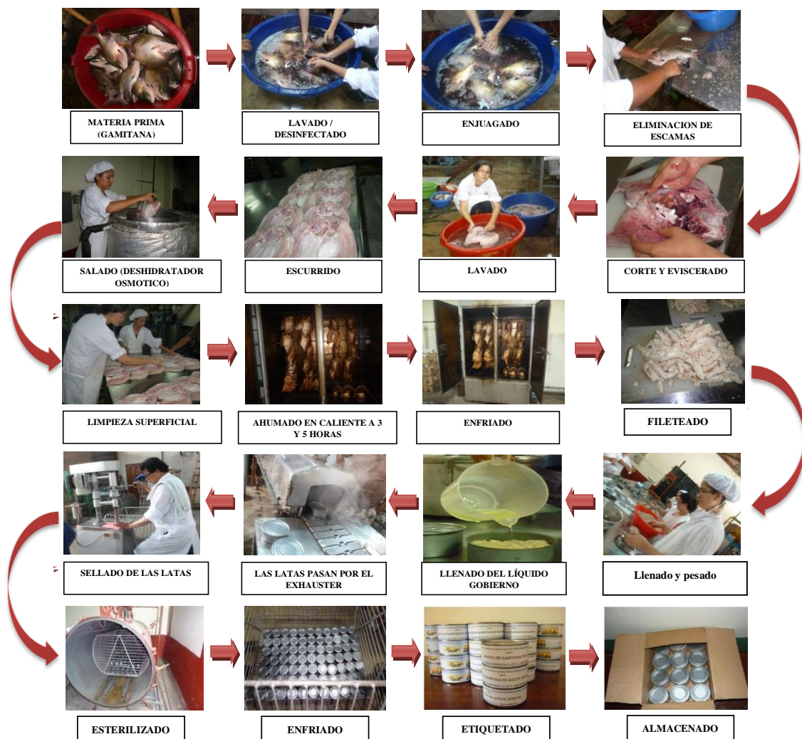
Figura N° 12 Flujograma de proceso e imagen para obtener conservas ahumadas en caliente tipo filete a partir de la especie Colossoma macropomum (Gamitana).
