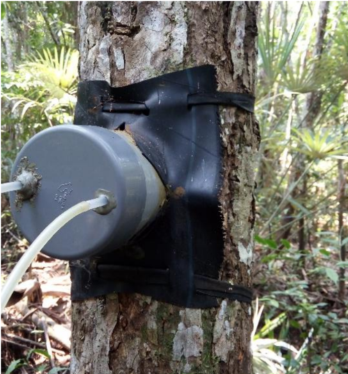
Figura 21. Programando al equipo Gas Hound Li-800, para medir el flujo de CO 2 por los fustes de árboles.
