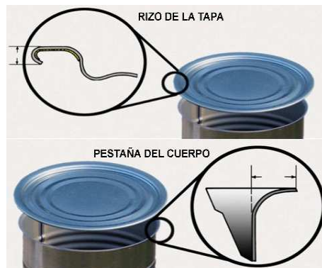
Figura N° 24: Rizo de la tapa y Pestaña del cuerpo [51].
