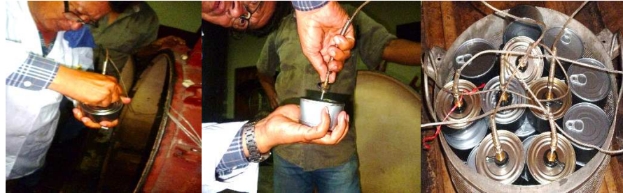
Figura N° 06: Latas insertadas con los sensores de pares termoelectricos.
