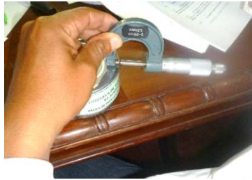
Figura N° 26: Medición del doble cierre de la conserva utilizando el micrómetro
