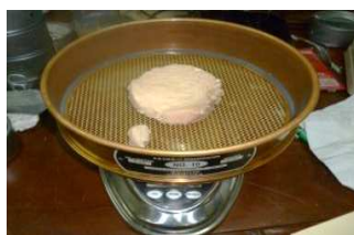
Figura N° 29: Balanza y tamiz N° 10 con el grated escurrido
