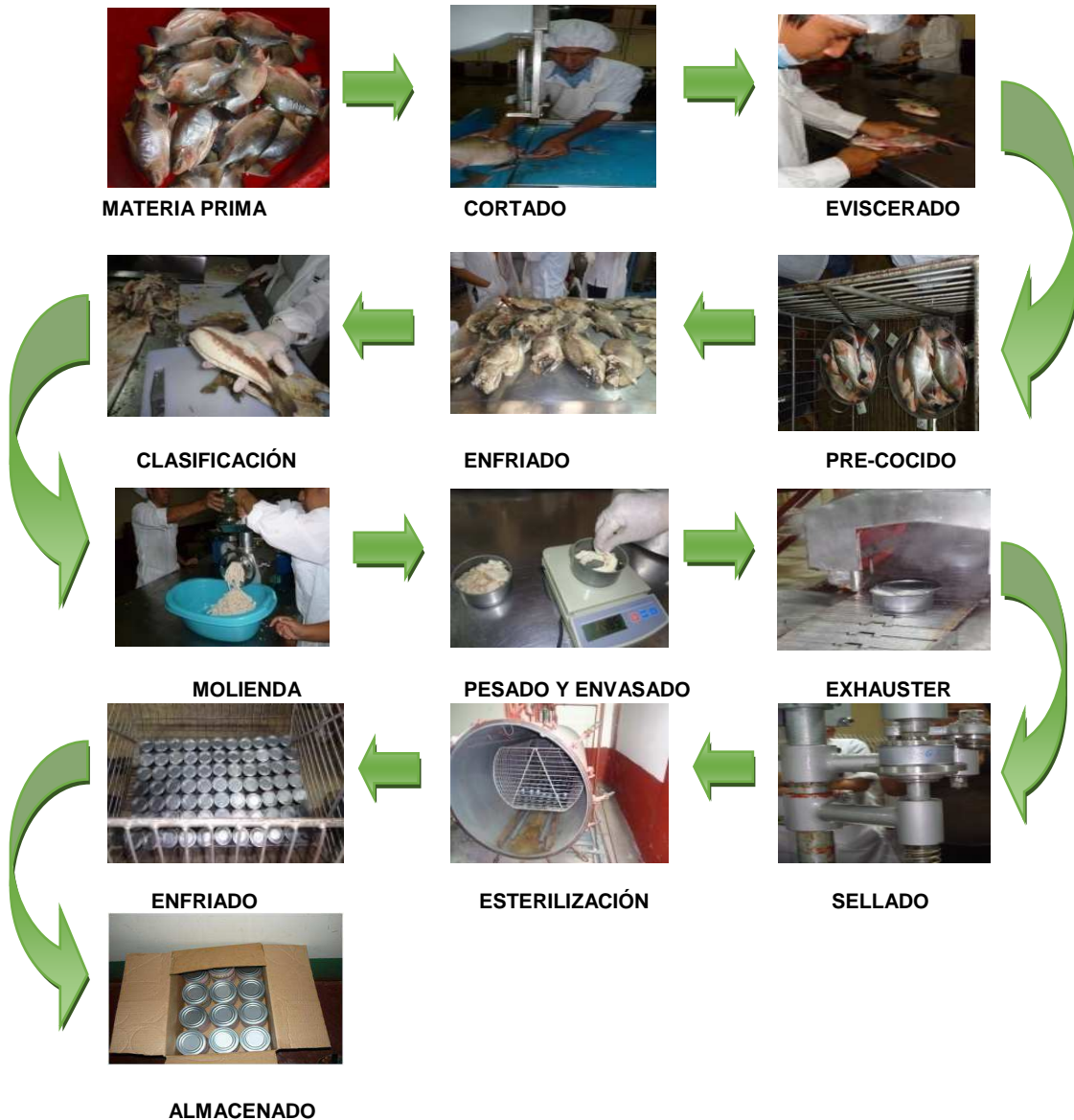
Figura N° 17: Flujo de proceso e imagen para obtener conserva de gamitana en cocido
