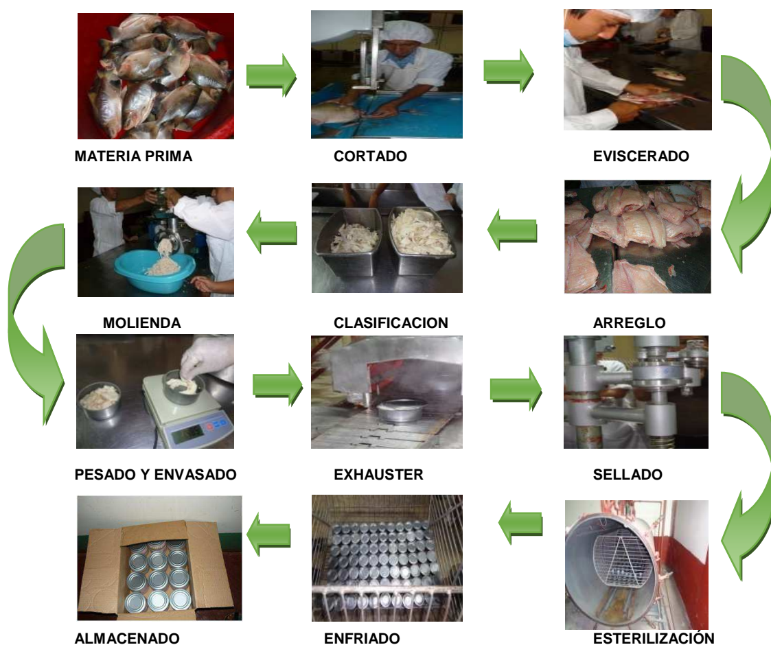
Figura N° 18: Flujo de proceso e imagen para obtener conserva de gamitana en crudo
