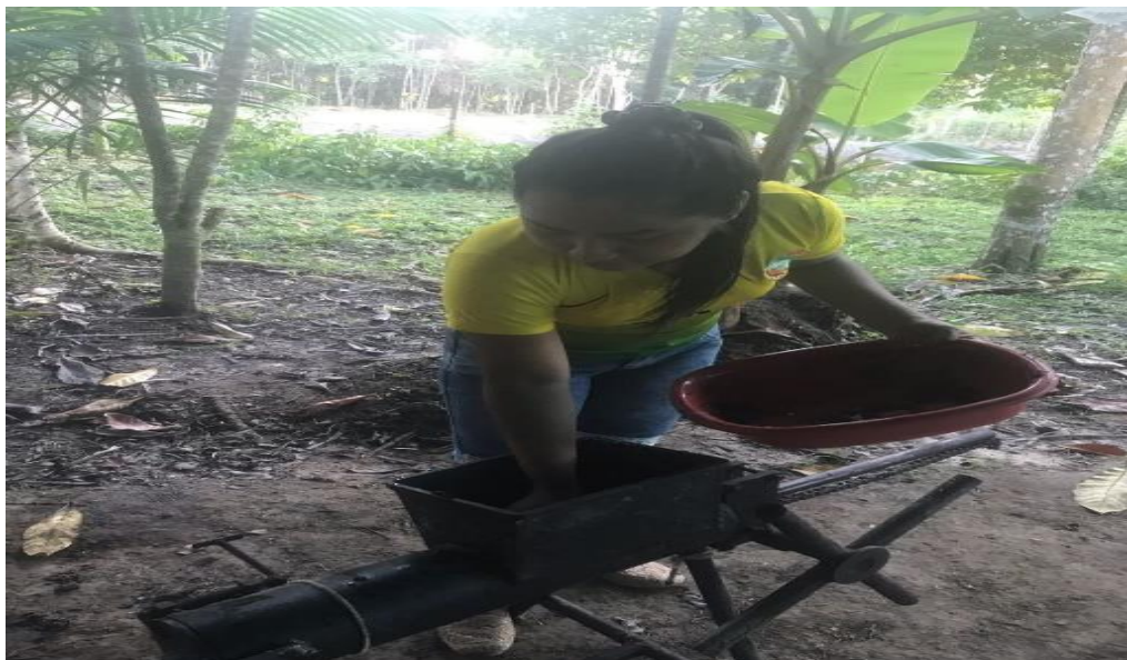
Echando mezcla del material orgánico y papel periódico a la maquina prensadora.
