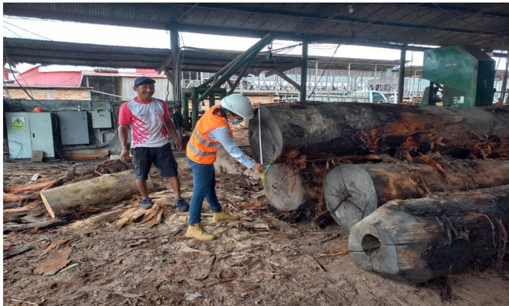
Foto 03. Determinación de la longitud de la troza de Palisangre
