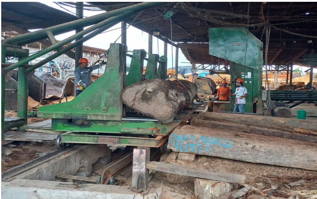
Foto 02. Transformación de madera en troza a aserrada de la especie Pali sangre
