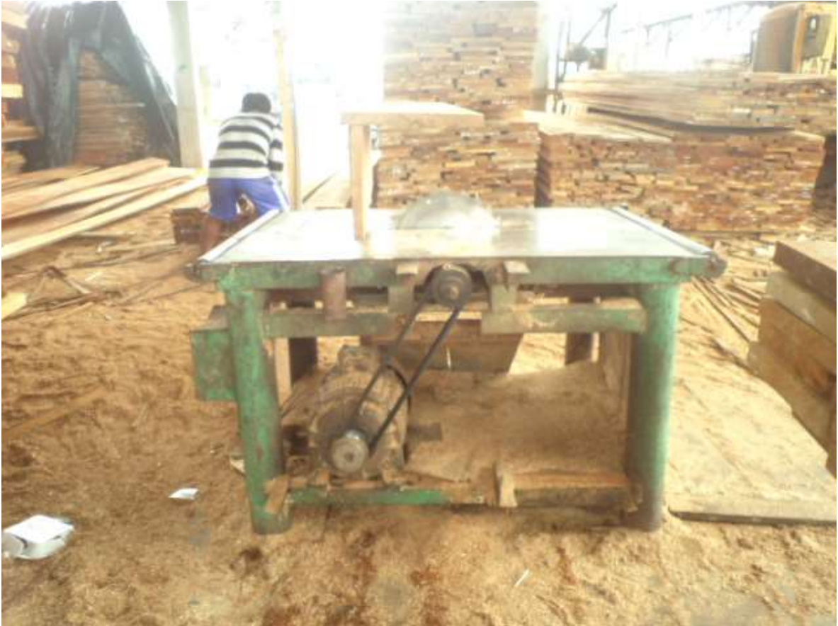
Figura 02: Mesa canteadora de tipo artesanal de la empresa SICO MADERAS SAC
