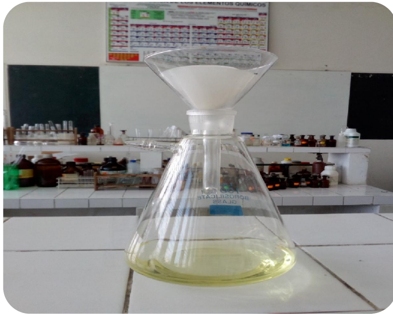
Foto 7. Filtrado del aceite esencial para separar el sulfato de sodio anhidro
