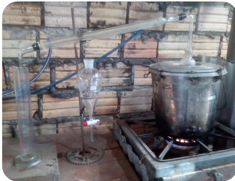
Foto 8. Extracción de aceite esencial de Ocotea aciphylla en una planta de campo
