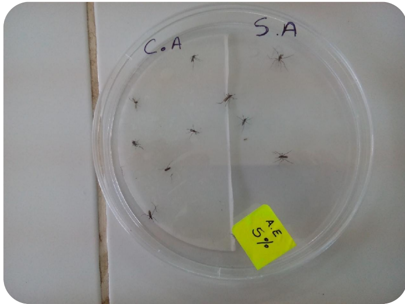
Foto 3. Test de repelencia con solución al 5% de aceite esencial
